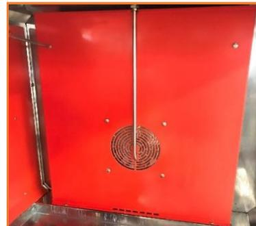
2. Avant de commencer, la rôtissoire doit être vide et l'écran tactile doit être sur la page d'accueil. Nettoyer le panneau et le fond en pulvérisant du produit "DECA-ONE" et en frottant à l'aide d'un grattoir.
