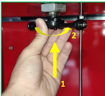
2. Dévisser le bras de lavage à la main. Laisser tremper dans le produit anticalcaire "ANTICA-ONE". Le remonter à la main une fois le nettoyage effectué.
