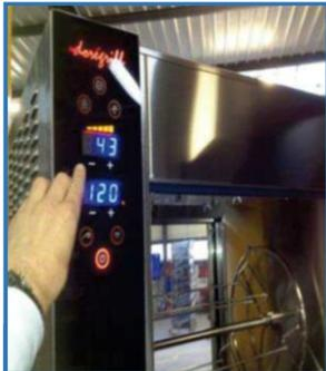
1. Avant de commencer, la rôtissoire doit être vide ainsi qu'à une température inférieure à 50°C (indiquée sur l'afficheur).
