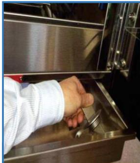
2. Dévisser le bouchon du bac de récupération et vider la graisse à l'aide d'un seau. Une fois la graisse évacuée remettre le bouchon en place
