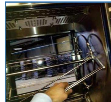
3. À la fin du cycle de nettoyage (15min se sont écoulées) vous pouvez retirer les balancelles pour terminer leur nettoyage.
