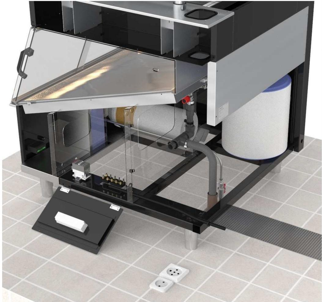
Il faudra prendre en compte les dimensions de la base de la vitrine D-BOX pour installer l'arrivée d'eau 15/21 mâle. Le placement exact du robinet mâle au sein de l'espace reste, quant à lui, libre (Il sera préférable cependant de l'installer à proximité de l'évacuation)
