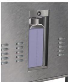
**Attention** de vérifier si il y a assez de produit avant de lancer le nettoyage. (voir schéma pour procédure et remplacement du bidon de produit) [page](#)
